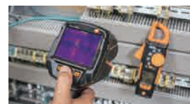
クランプメーターとの組み合わせで電流・電圧・電力も同時に測定可能
