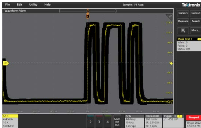
高品質なリファレンス信号に基づくリミット・マスク・テスト
