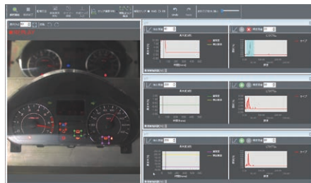
物体の輝度変化(メータLED点灯切れ)
