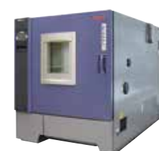
ハイストレス温度 サイクル試験装置
