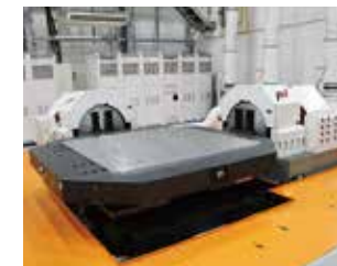
大型3軸耐震試験装置
