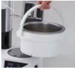
水槽部は取外しができるので、電源コンセントを抜くことなく水の交換、清掃が簡単に行なえます。(SB-1350型)
