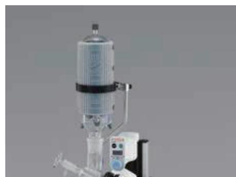
ロータリーエバポレーターの冷却器やノズル部に専用カバーをそれぞれ取付けることで、結露（結露水）の発生を軽減できます。現行製品だけでなく、今までに発売した従来製品にも取付けが可能です。（詳細はP.23参照）
