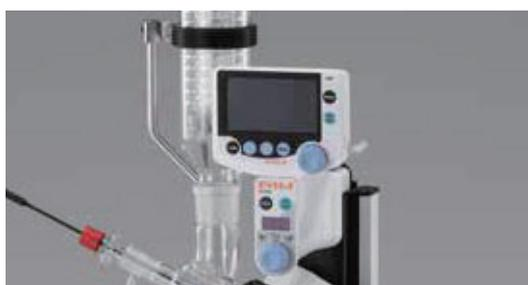
真空コントローラーNVC-3000型、溶媒回収ユニットDPE型シリーズと接続することで圧力コントロールだけでなく、ロータリーエバポレーターの回転数やバス温度、冷却水温度などの測定値の表示や設定変更(バスは除く)が可能です。(詳細はP.16参照)
