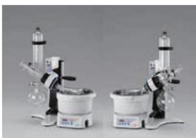
ガラスセットは左右どちらでも取付け可能です。セッティング時に実験台のスペースや利き手を考慮して装置を設置することができます。
