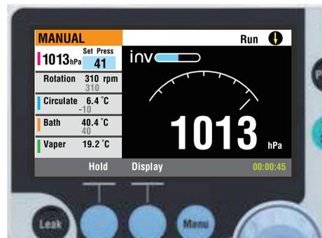
真空コントローラーは通信機能を搭載したシステム周辺機器（ロータリーエバポレーター、ウォーターバス、オイルバス、冷却水循環装置、ダイヤフラム型真空ポンプなど）を一括で制御可能です。（詳細はP.15参照）
