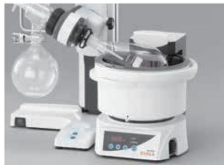
水専用バス (SB-1350型) は上限温度アラーム、フロートスイッチ、固定温度過熱防止器、バス検知器などの安全機能を標準装備。水槽部 (バス・取手付カバー) の取外しができ、水の交換、清掃が簡単に行なえます。(詳細はP.20参照)
