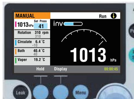
真空コントローラーは通信機能を搭載したシステム周辺機器 (ロータリーエポレーター、ウォーターバス、オイルバス、冷却水循環装置、ダイヤフラム型真空ポンプなど)を一括で制御可能です。(詳細はP.15参照)
