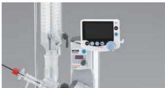
真空コントローラーNVC-3000型、溶媒回収ユニットDPE型シリーズと接続することで圧力コントロールだけでなく、ロータリーエバポレーターの回転数やバス温度、冷却水温度などの測定値の表示や設定変更(バスは除く)が可能です。(詳細はP.16参照)
