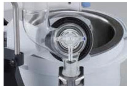
冷却器の取付け位置をキャピラリーからずらしているため、冷却器からの凝縮液がキャピラリーをつたって試料フラスコ側に逆流する心配がありません。
