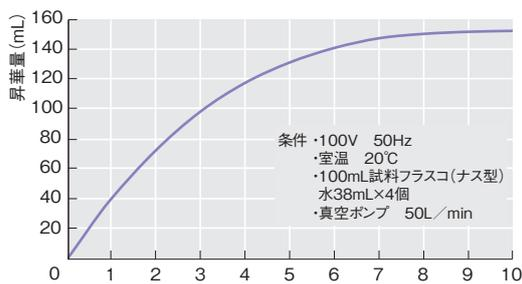
試料(水)を試料フラスコ(ナス型)に入れ、予備凍結後にトラップに取付け、時間経過後のフラスコの残量から昇華量を逆算しています。
