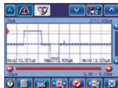
簡易輪郭形状解析例 (凸段差)
