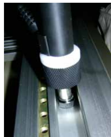
●隙間や溝、浅い段差部分の硬さ試験
