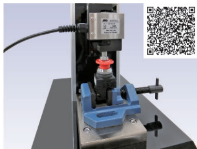
包装容器の圧縮強度試験
