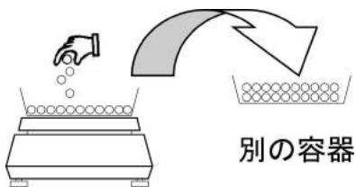
手順1で加算したサンプルを別の容器に移し、追加計量するサンプルを載せます。
