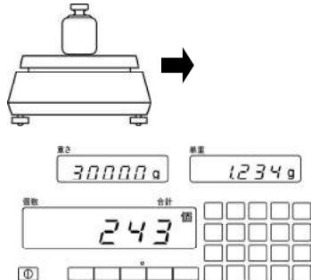
調整用外部分銅を計量皿の中心に載せます。
