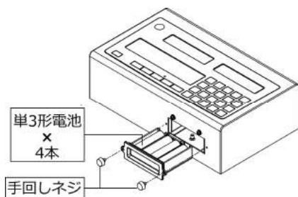
(1) 手回しネジを回し、電池ケースを取り外します。
