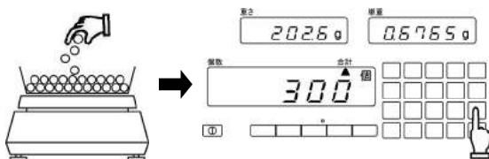
サンプルを風袋容器に載せ、**加算**キーを押します。
