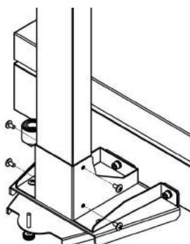
手順 5 で外した 4 本のネジでポールベースにポールを固定します。
