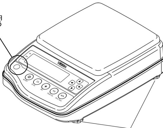
底面4箇所のアジャスタを左右に回して傾きを調整
