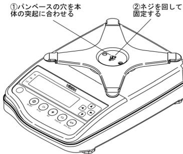
本体の突起にあわせてパンベースを載せ、コインなどでネジを回して固定します。
