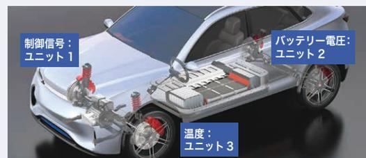
データ更新間隔に連動するカットオフ周波数がユニットごとに設定、強いフィルター効果が得られる「長いデータ更新間隔」と、「短いデータ更新間隔」をそれぞれ設定し同時に測定ができます。
