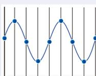
ユニットごとに A/D コンバータを搭載。ユニットを増設しても最高サンプルング速度は落ちません。
