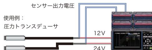
2 端子の電圧出力端子を装備。各端子から 100mA の電流供給ができ、センサーの電源を別途用意する必要がありません。VOUTPUT1 端子からは 5V/12V/24V が選択でき、VOUTPUT2 端子からは 5V/12V が選択できます。
