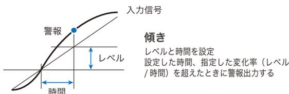
8 チャンネルの警告出力を設定可能。監視したい各チャンネルにレベル、ウィンドウ、傾き、ロジックパターンの警告種類を設定できます。
