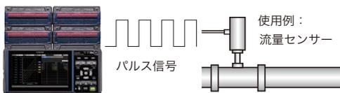
回転数設定ではモーターやドリルなどの回転ムラ測定により生産設備の状況モニターに、積算設定では電力量積算や流量積算の測定により工場管理のデータ取りにそれぞれ活用できます。
