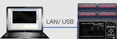
標準付属のアプリケーションソフトウェア Logger Utility で、リアルタイムに PC 上でデータを記録できます。記録中でも、過去の波形に逆スクロールして観測ができます。リアルタイム測定は記録間隔 10ms から可能です。
