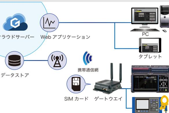
測定データをクラウドサーバーに保存する遠隔計測サービスです。PC やスマホの Web ブラウザを使って、いつでもどこでも「現場のいま」を知ることができます。ネットワークの知識を必要とせず、計測器とゲートウェイを LAN 接続するだけで、クラウドサーバーにつながります。
