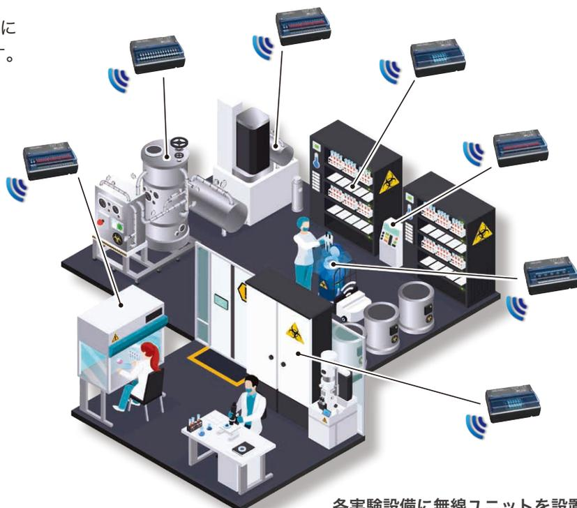
各実験設備に無線ユニットを設置
