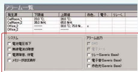
各種アラーム設定 システム全体、または各プローブの アラームを選択して設定できます。
