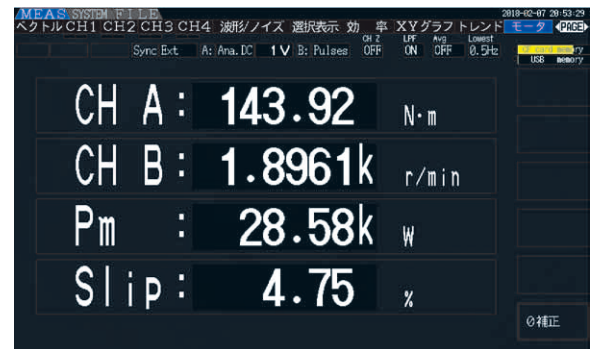
モータ解析画面 (トルク、回転数、モータパワー、すべり) CH B にエンコーダの Z 相パルスを入力すると電気角、B 相パルスを入力すると回転方向を測定できます
