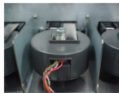
DCCT 電流センサ (PW3337 内部)
