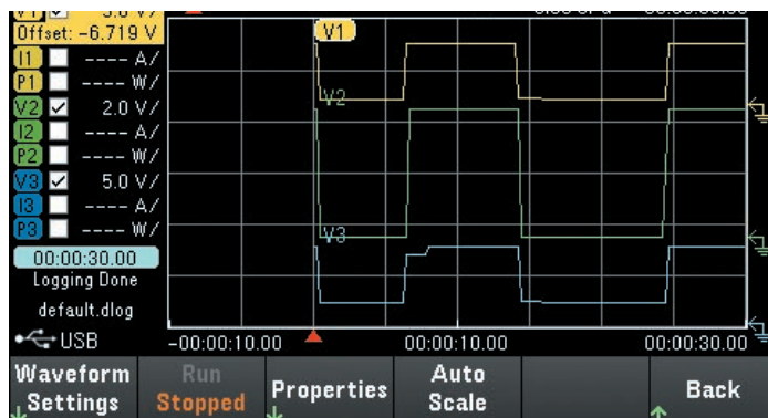
図1. 「データ・ロガー・ビュー」では、複数のデータを記録できます。この図では、出力1、出力2、出力3の電圧を30秒間捕捉しています。
