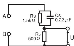
●測定回路網(ネットワークE 電気用品安全法など)
