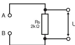
●測定回路網(ネットワークC IEC60990 図5 U3測定に準拠)
