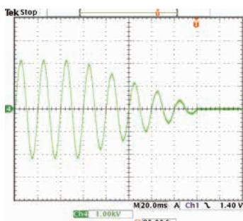
AC / DC 耐電圧試験の PASS 判定時には、徐々に試験電圧を降下させることができます。電圧降下時間は 0 s ~ 200 s まで 0.1s 分解能で設定可能 (OFF も可) です。
