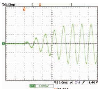
AC / DC 耐電圧試験では設定電圧まで徐々に電圧を上昇させるライズタイムコントロール機能を搭載。電圧上昇時間は 0.1 s ~ 200.0 s まで 0.1s 分解能で設定可能です。
