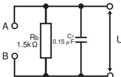
●測定回路網(ネットワークB1 IEC60990 図4 U1測定に準拠)
