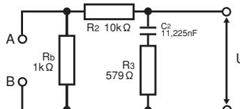
●測定回路網(ネットワークB IEC60990 図4 U2測定に準拠)
