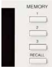
試験電圧、判定値、試験時間はキーを押してパネル中央のノブを回すだけ。一度設定した試験条件はパネルメモリに記憶させることができます。(3 セット)
