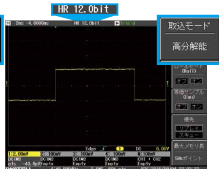
High Resolution(高分解能)12ビット分解能相当時 (サンプリング速度2.5MS/s、電圧レンジ2mV/div)
