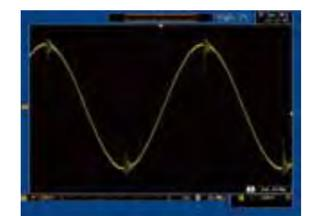
正弦波にパラメタ可変波形の減衰振動波を加算して、任意波形として出力。
