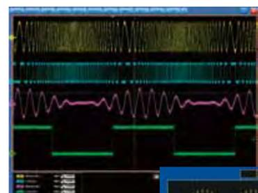
● CH1とCH2の主出力は正弦波で振幅変調
