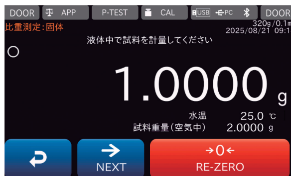
固体試料の比重測定
