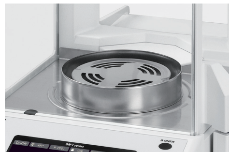
高さのある風防リングを備えた穴あき計量皿
