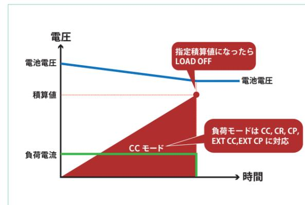
積算電流(電流)設定時の動作イメージ(CCモードの場合)
