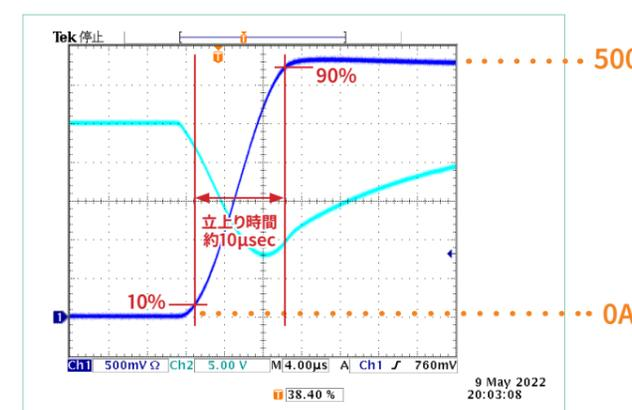
※一般的にスルーレートは負荷電流が最大値の10%から90%に至るまで変化する時間と電流の変化率となります。
