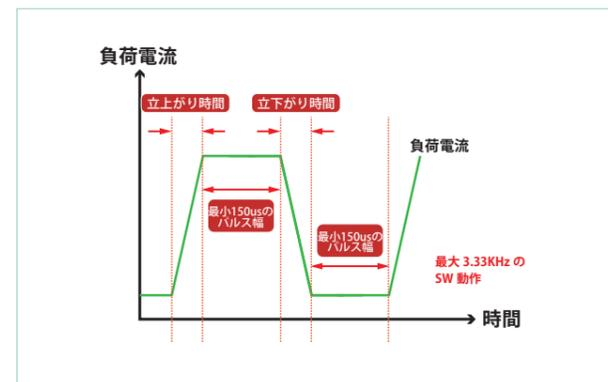
QL-Dシリーズの場合(高速電流制御回路方式)
