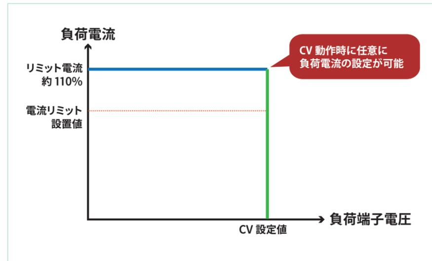
CV + Clim モード動作 (定電圧 / 定電流動作)
