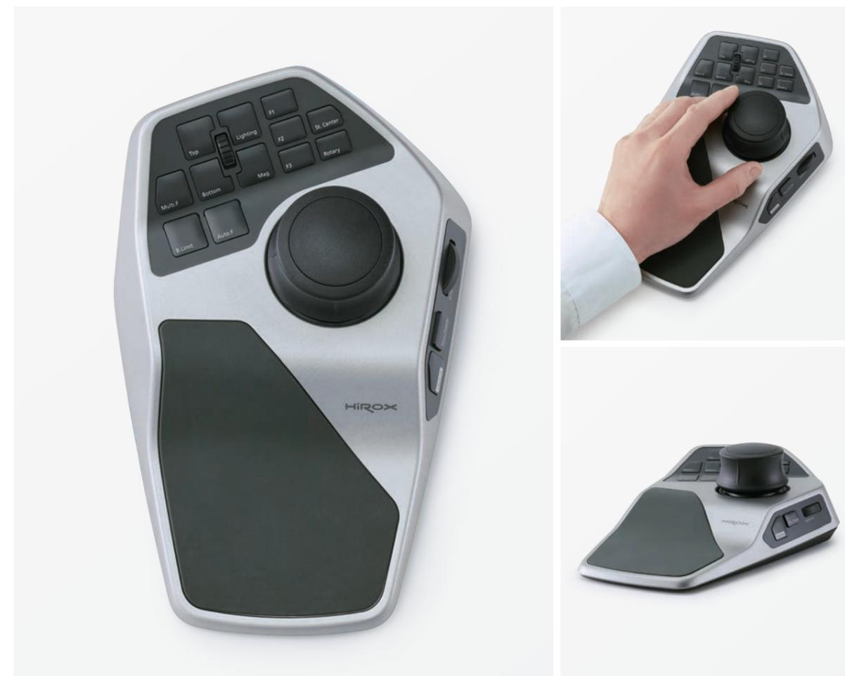
倍率・照明・フィルターの切替、XYZステージ操作と電動制御が可能となったことから、手元で様々な操作が可能な専用コントローラーを開発しました。ジョイスティックは直観的にXYZ移動を制御でき、15個のボタンはアプリケーションのファンクション割り振りなど連動しており、誰もが直観的な観察作業が可能となります。
