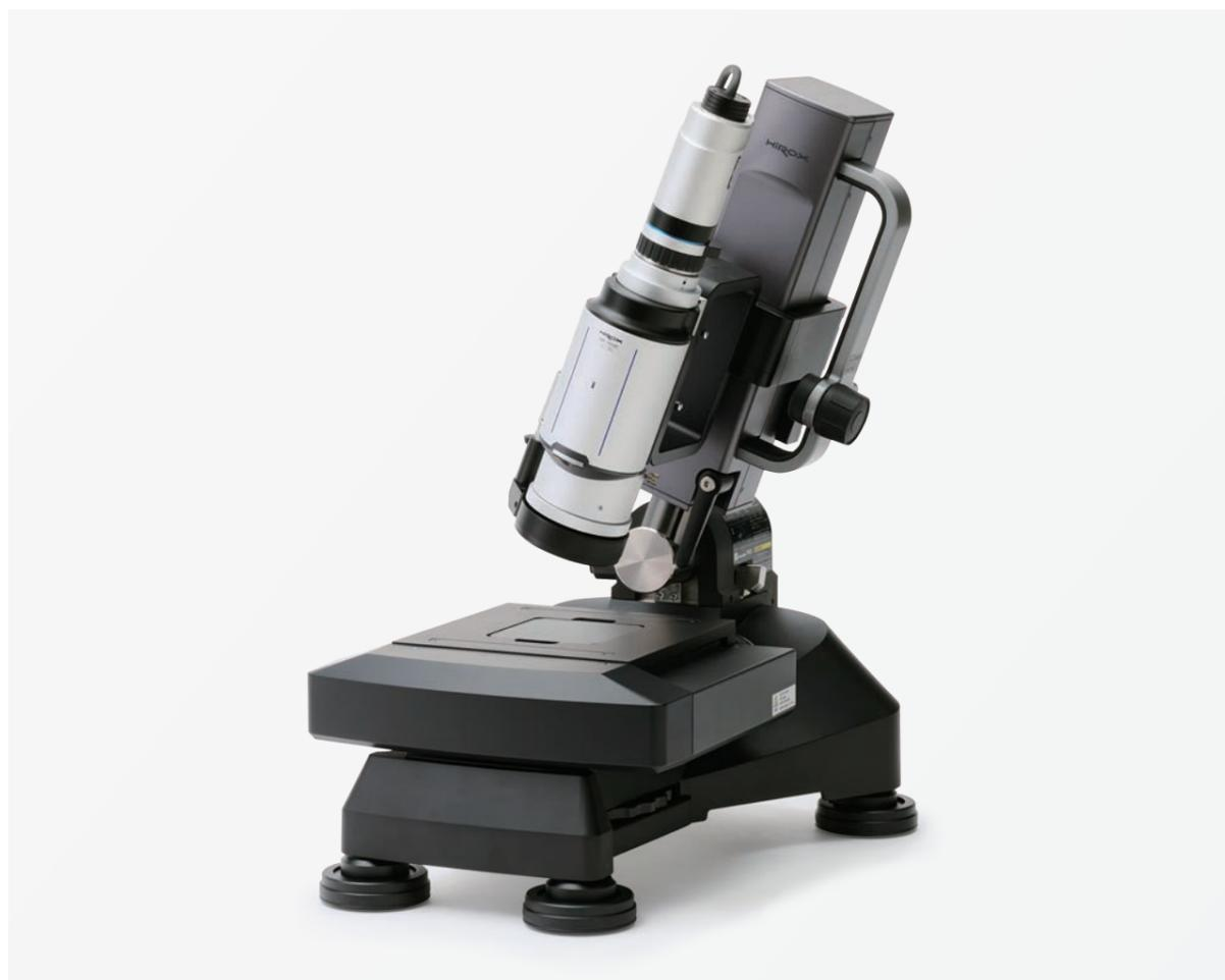
Z軸ブロックはヨーイング、ピッチングの制御が向上し、深度合成がより鮮明になりました。電動XYステージは50mm×50mm、100mm×100mmのサイズに対応し、大きい対象物にも対応可能です。
