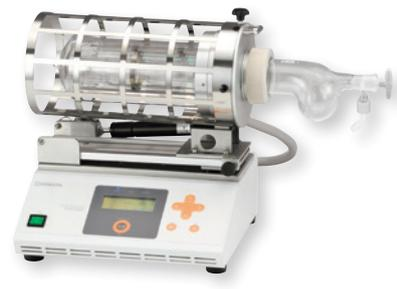
減圧下において少量サンプルの蒸留・分留・濃縮が行える回転加熱型と、サンプルの乾燥を目的とした乾燥型の2種類をラインナップ
