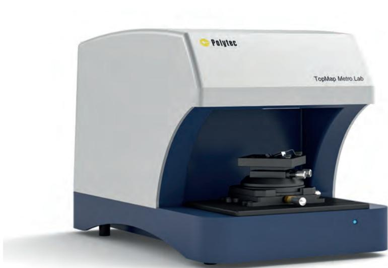
ポリテックの TMS-150 TopMap Metro.Lab は、広い垂直方向の測定レンジを持つ高精度の白色光干渉計(コヒーレンス走査型干渉計)です。TopMap Metro.Lab は、大きな面や構造物の平面度、ステップ高さ、および平行度を非接触で測定するのに最適です。柔らかい素材や繊細なものにも適用できます。
