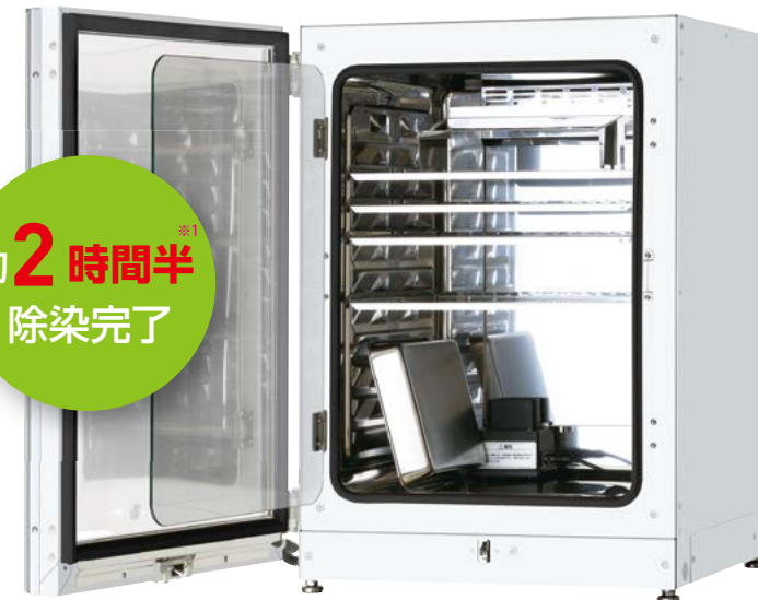
◎MCO-170AICUVH 除染時の器内レイアウト
