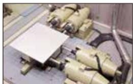
6自由度振動試験装置 (動電式)
