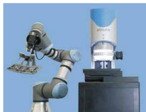
搬送ロボット「Pick & Place」とオートメーションマネージャー、マルチ測定機能、アリコナインスペクトを組み合わせることで、搬送から測定、測定後の仕分けまでを自動的に実行することが可能です。
