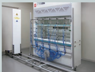
多点風速計による風速測定
