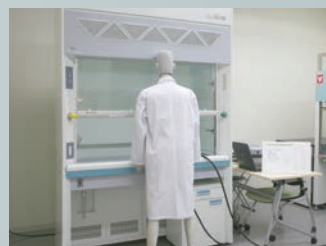
ASHRAE 試験 定位試験
