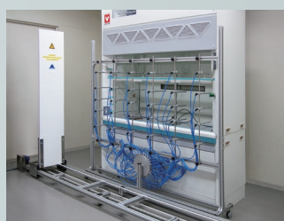
多点風速計による風速測定
