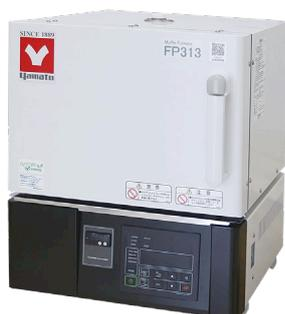
炉内にヒータが露出していないのでコンタミを少量に抑えることができます
