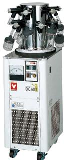
ピラニ真空計により、精度の高い凍結乾燥ができます
