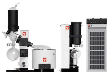
真空コントローラーにインバータ制御の真空ポンプを組み合わせた使い易さと省スペースを実現した組み合わせです。更に2次トラップも付けて回収効率をアップした環境対策や臭い対策にも配慮した推奨モデルです。
