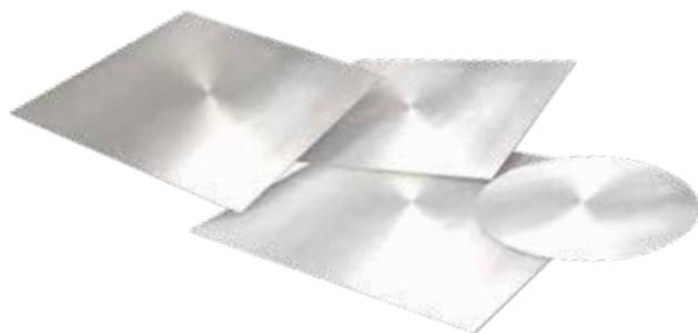
LFA 467 HyperFlash®: 厚みの異なる複数の銀板試料で熱拡散率値が文献値とよく一致している
