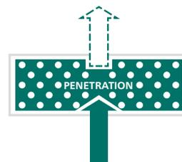
標準的なフラッシュ法の測定では、パルスエネルギーが試料の表面で完全に吸収され、生じた熱が試料の厚みを通して裏面に到達するものとしています。しかし、多孔質の材料ではパルスエネルギーの吸収が表面に限定されず、試料厚み分の薄層内にも広がります。多孔質材料用の計算モデルはこの浸透効果と温度分布の減衰を考慮します。
