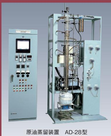
原油蒸留装置 AD-28型
