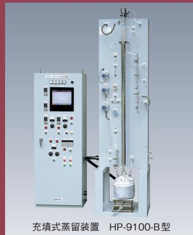
充填式蒸留装置 HP-9100-B型
