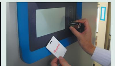
停電時にはバッテリーの電源を利用し、扉のロックを解除することが可能です。また、バッテリーが切れた場合でも9V角型電池で対応可能です。
