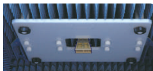
アンテナ固定台 最大5つのホーンアンテナを取付可
