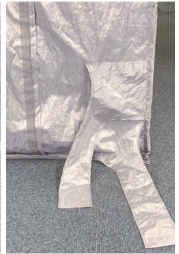
ケーブル通線口
