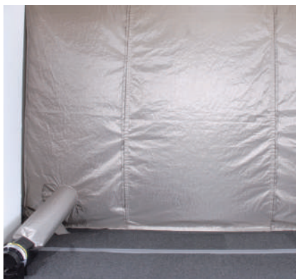
正面扉 シールドテント 閉口時
