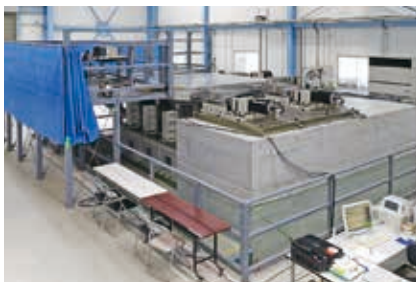
大型3軸振動試験装置 鉄道車両規格、地震シミュレーション対応 テーブルサイズ2800×2800mm
