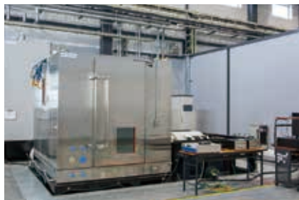
200kN 大型複合環境試験装置 最大加振力200kN テーブルサイズ2000×2000mm
