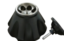
固定角ロータ TLA-110 最高回転数: 110,000 rpm 最大遠心力: 657,000 xg \kappa ファクタ: 13
