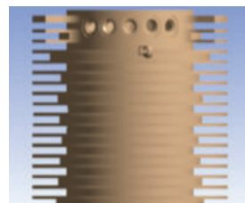
新ドライブ・冷却フィン 新しくフィンの形状を変更することにより、 どの回転数でも共振を抑えることが可能
