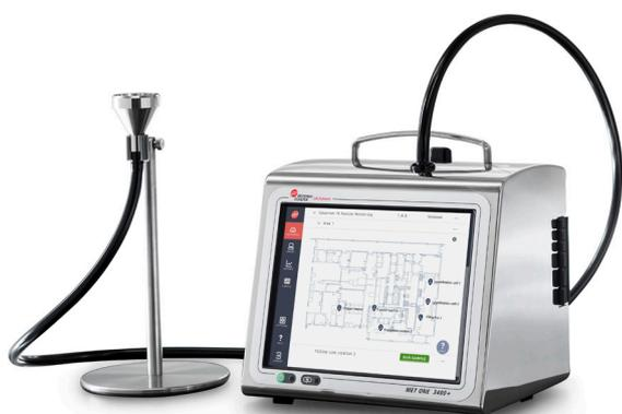
新発売のポータブル型 気中パーティクルカウンター MET ONE 3400+ シリーズは、自動化された SOP とサンプリングマップを統合できる機能を搭載し、多くのトレーニングの必要なく、サンプリングエラーを削減します。
