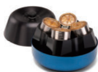
JLA-9.1000 最高回転数：9,000 rpm 最大遠心力：16,800 xg 容量：4本×1,000 mL 重量：10.8 kg(本体セット時)
