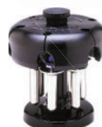
JS-24.15 最高回転数: 24,000 rpm 最大遠心力: 110,500 xg 容量: 6本×15 mL
