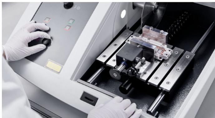
シンプルなユーザーインターフェイスが非常に容易な操作を可能にします。多機能ノブでパラメータを設定し、ジョイスティックを使用して試料を迅速に位置決めするだけです。
