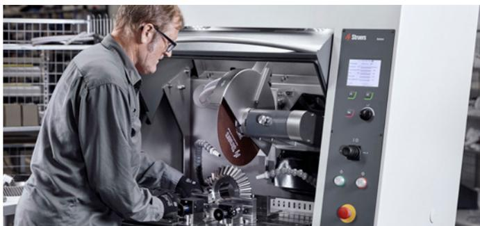
Axitomのオーバーロード保護とインテリジェントな送り制御システム、オプティフィードがモーターを損傷や予期しない停止時間から保護します。また、この機械は驚くほど頑丈で強固なため、大型試料の切断時の振動を最小限に抑え、耐用年数の延長に貢献します。
