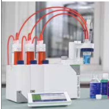
研究・製造環境では、多くの測定と分析が同時に実行されています。すべての異なる機器を追跡することは、効率的なワークフローを維持するための鍵となるタスクです。StatusLight<sup>™</sup>は、機器の状態を常にライトの色で視覚的に管理します。判断や操作が必要な場合は音信号を発信し、滴定プロセスを適切に実行できます。ラボのどこからでも滴定の状態を把握することができます。
