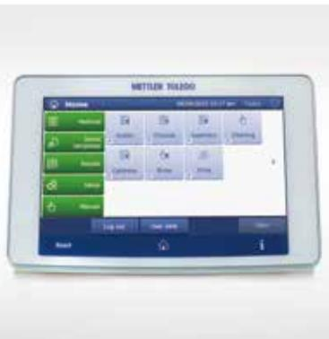
Excellence滴定装置シリーズでは、結果をすばやく容易に取得することができます。ユーザーごとに設定可能なショートカットは作業効率を向上させます。電極の校正、ビュレットの洗浄メソッドの開始など、希望の操作のショートカットを定義し、これをご自身のホーム画面に保存するだけです。
