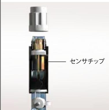
Excellence 滴定装置シリーズの機器はプラグ&プレイセンサを自動的に認識します。すべての関連データはセンサチップに保存され、滴定装置に自動的に転送されるため、いつでも正しいセンサを確実に使用できます。
