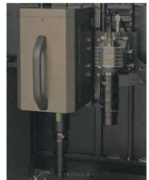
2D 分光放射計 SR-5100HM を併用した補正システム
