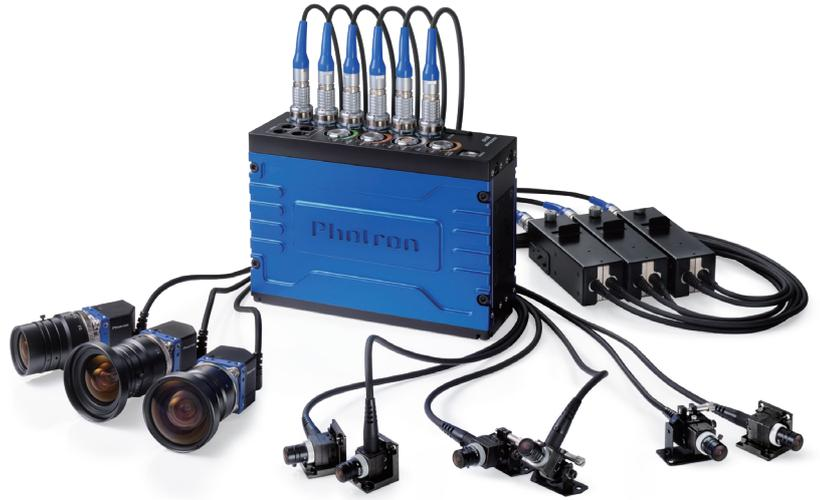
「FASTCAM MH6」 「FASTCAM MH6 type LT」は、メインユニット1台に約15mm角の超小型カメラヘッドを最大12ヘッド、35mm角のフルHDタイプ小型カメラヘッドは最大6台接続できるマルチヘッド方式のハイスピードカメラです。2種類のカメラヘッドは混在接続できるため、一度の試験で全体挙動、詳細挙動の同時撮影も可能です。
