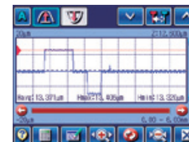
簡易輪郭形状解析例 (凸段差)
