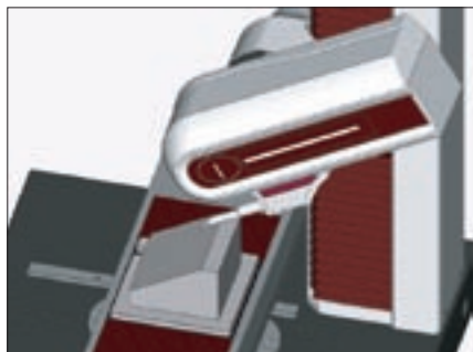
X軸方向の斜面測定
