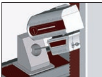
X軸方向の斜め穴測定
