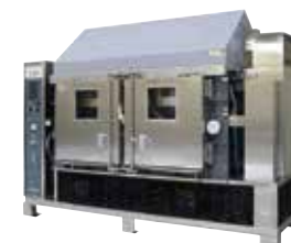
腐食促進試験装置
