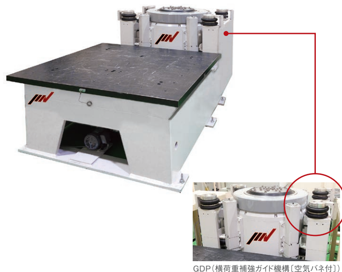
GDP (横荷重補強ガイド機構〔空気バネ付〕)
