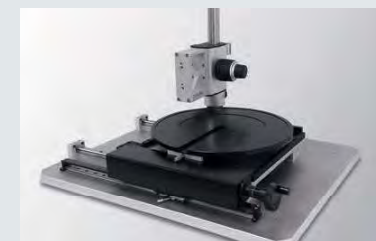
円盤状の対象物を回転させながら、端から中心まで観察できるスタンド。12インチウェハにも対応。
