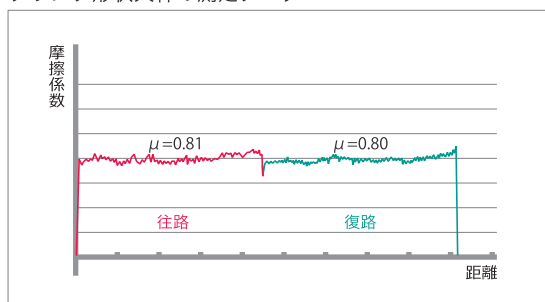
クランク形状天秤の測定データ
